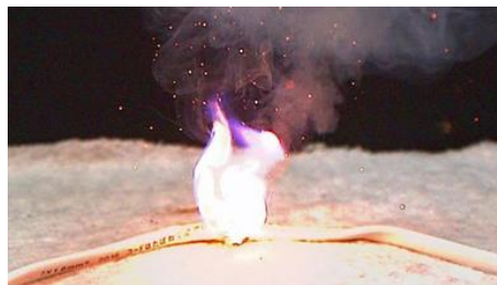
断線した電源コードの発火
